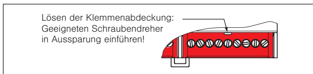
Abb. 3 Lösen der Klemmenabdeckungen
