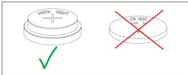
Abb. 10 Korrekte Akkus mit Polarität
