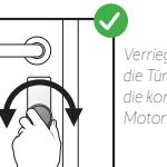
Verriegeln und Entriegeln Sie die Tür mit dem Drehknopf um die korrekte Installation des Motors zu überprüfen.
