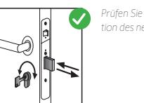
**Der neue Zylinder muss sich leicht bedienen lassen bevor Sie die Installation fortsetzen.**
