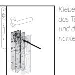
Kleben Sie die Montageplatte auf das Türblatt. Die Montageplatte und der Zylinder müssen ausgerichtet werden.
