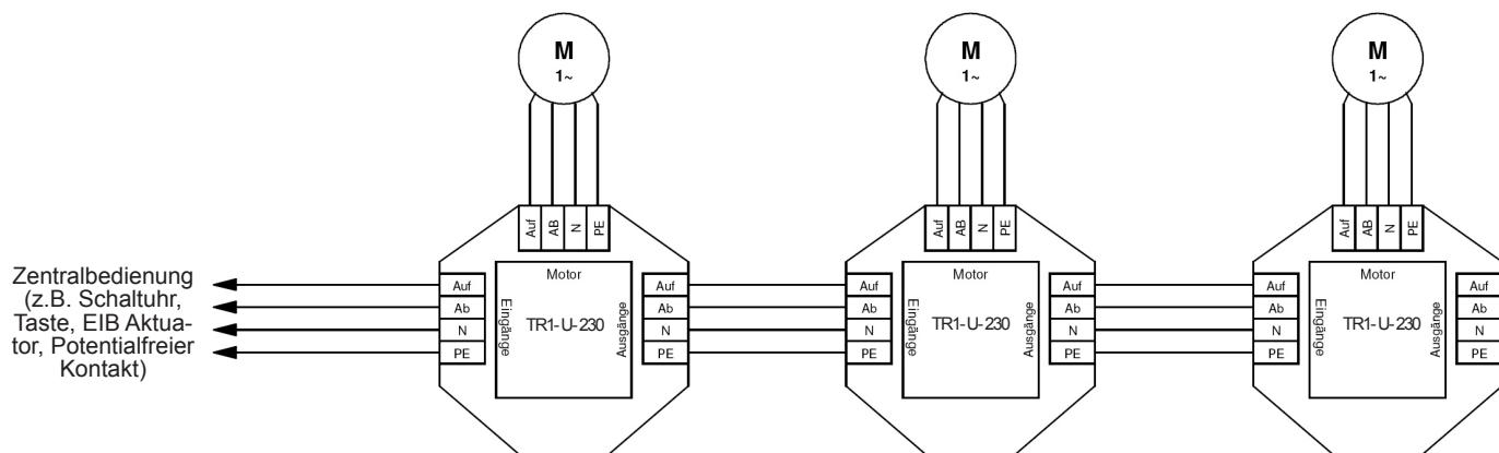
**Achtung: Bei dem Trennrelais TR1-U-230 fließt der Motorstrom bzw. die Summe der Motorströme über die Zentralbedienung.**
