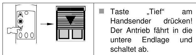
Abb. 2: richtige Einstellung für die untere und obere Endlage
