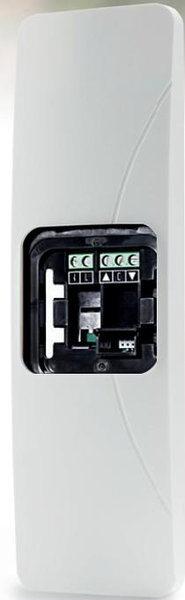
UniClic-Rahmen mit Netzteil zur Aufnahme von ProLine-Bedienteilen
