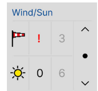
Vue rupture de câble / Perte des capteurs
