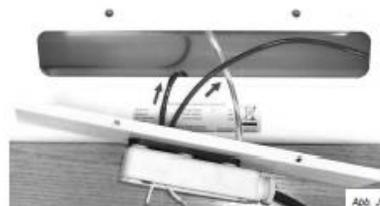
5. Die Kabel für den Heizstab nacheinander durch die Platte ziehen (Abb. J).
