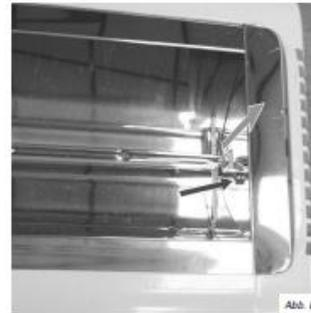
7. Die Schraube (Abb. L) vom Seitenreflektor entfernen und den Reflektor nach oben vom Heizstrahler abziehen. Den anderen Seitenreflektor auf der gegenüberliegenden Seite genauso entfernen.
