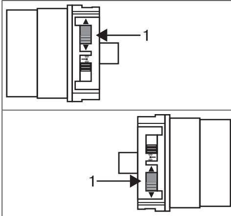
Schieben Sie den Drehrichtungsschalter (1) in die gegenüberliegende Position.
