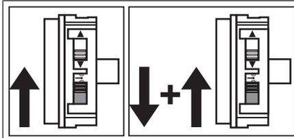
Schieben Sie den Funkschalter in die innere Position. Falls sich der Funkschalter schon in dieser Position befindet, schieben Sie den Schalter nach außen und wieder auf die innere Position zurück.
