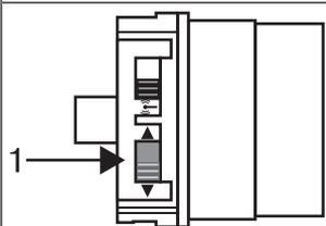
Schieben Sie den Drehrichtungsschalter (1) in die gegenüberliegende Position.
