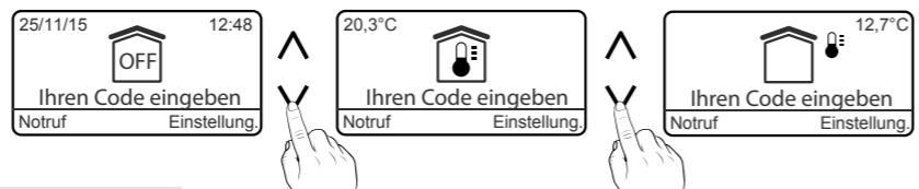
Die Innentemperatur wird von der Tast-Bedieneinheit gemessen. Die Außentemperatur wird von der Außensirene gemessen.
