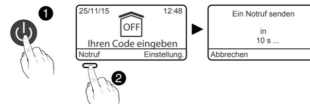
Geben Sie den Zugangscode ein und drücken Sie auf OFF, um das aktuelle SOS-Signal zu unterbrechen.
