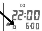
Die Sonnenautomatik wird nach der Schaltzeit AUF automatisch aktiviert und nach der Schaltzeit AB wieder deaktiviert. Dies heißt bei normalem Einsatz: die Sonnenautomatik ist bei Tag eingeschaltet und bei Nacht ausgeschaltet. Bei ausgeschalteter Sonnenautomatik wird im Display ein **□** angezeigt. Sie können die Sonnenautomatik bei Tag auch manuell ein- bzw. ausschalten.
